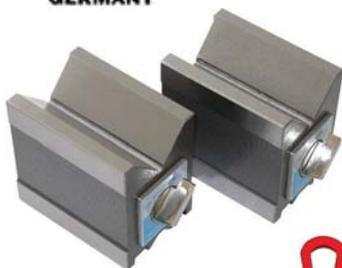
Tipo magnetico. Inserimento e disinserimento mediante interruttore.
